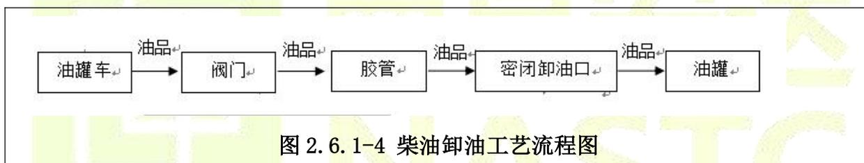
图 2.6.1-4 柴油卸油工艺流程图
