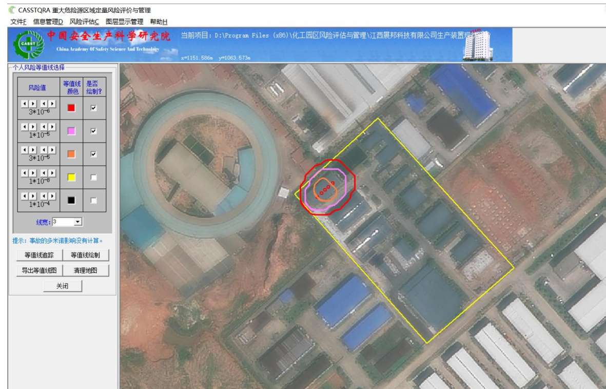
图 5.3-2 本装置所属设施个人风险等值线图
