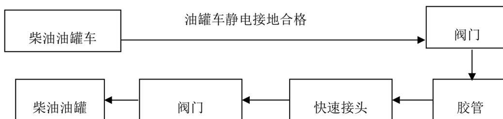
图 2-3 柴油卸油流程图
